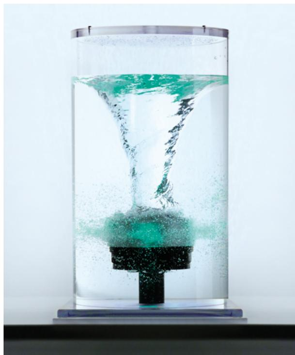
Возможно, двигателям никогда не придется работать под водой, но мы все равно испытали их: 1700 часов безотказной непрерывной эксплуатации. Отличный результат!
