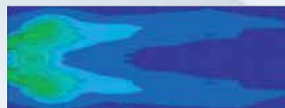
Распределение холодного воздуха без направляющей решетки
